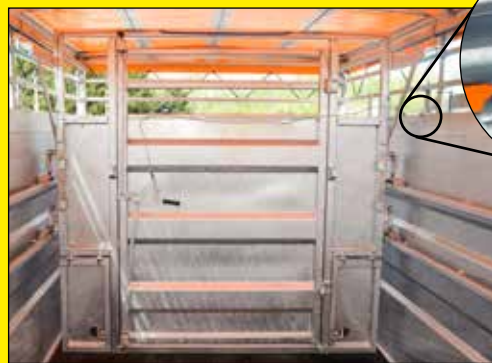
Binnendeur uitgerust met een hendel om veilig van buiten te open
