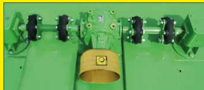
Overbrenging met viervoudige torsiebeveiliging
