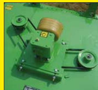
De verschillende rotors worden aangedreven door 2 V-riemen.
