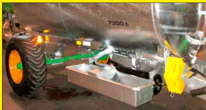
Drinkbak met constant niveau aan de zijde
