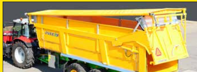
TELECOVER dekzeil verenigbaar met de hydraulische opzetschotten
