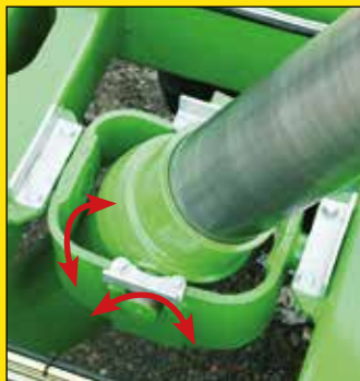
Dubbel schommelframe waarin de cilinder geplaatst wordt
