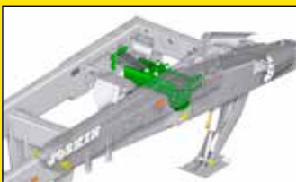
Dissilvering met parabolische veerbladen
