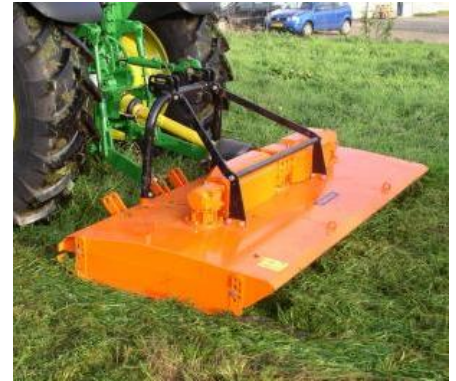
LK - tandwielkast aangedreven weilandbloter
