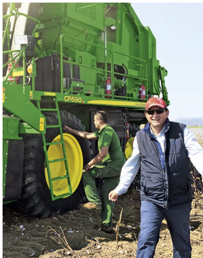
Eén man, één machine: Seref en zijn John Deere CP690, die vier hectare per uur kan oogsten.
