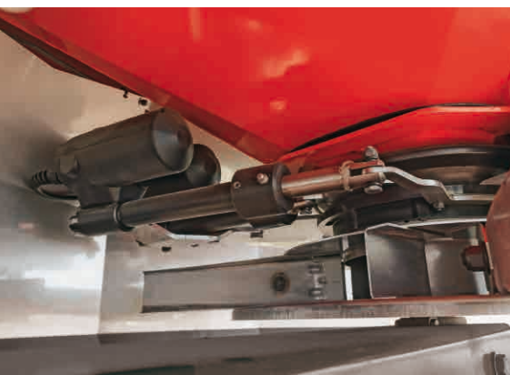
Twee spindelmotoren bedienen het uitstrooiptpunt (werkbreedte) en de gift op hetzelfde moment.
