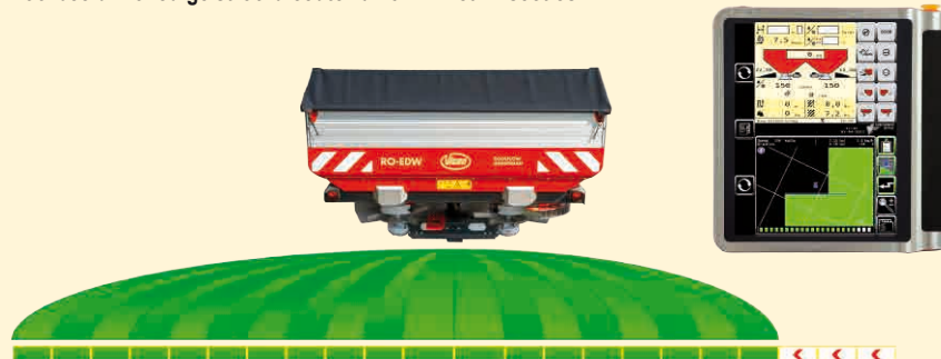
Strooibreedte rechts verkleind met 6 m.
