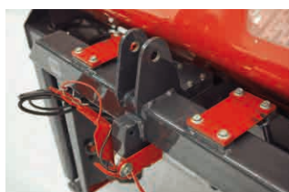
1 x 10 tons weegcel (RO-M EW) met unieke referentie sensor.
