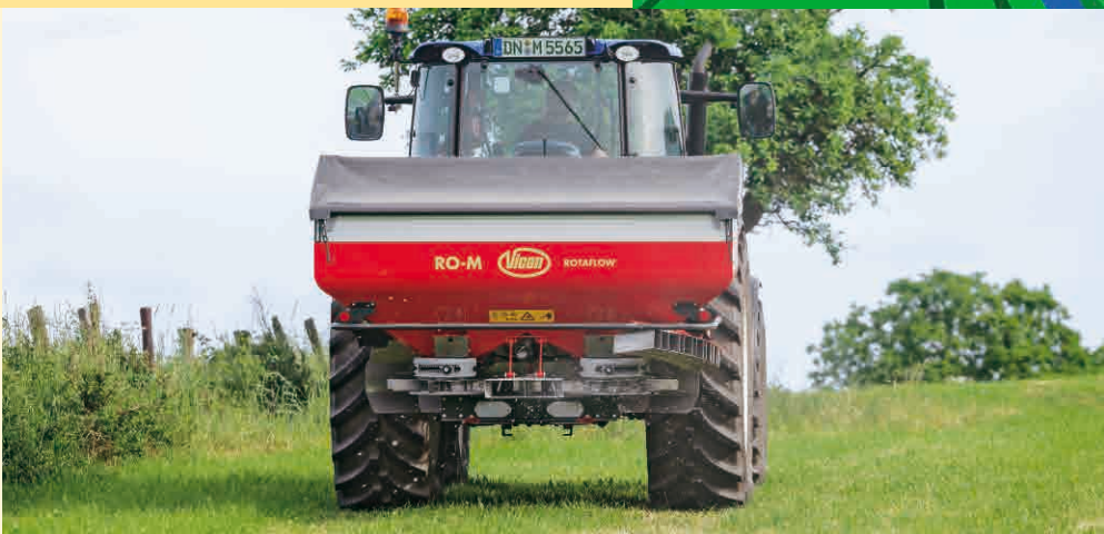
Van de kant af strooien met de kantstrooiplaat (mechanisch of hydraulisch leverbaar)
