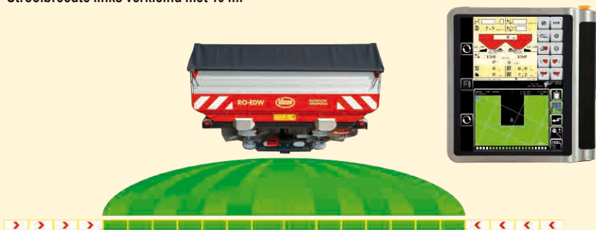
Strooibreedte beide zijden verkleinen met 8 m.
